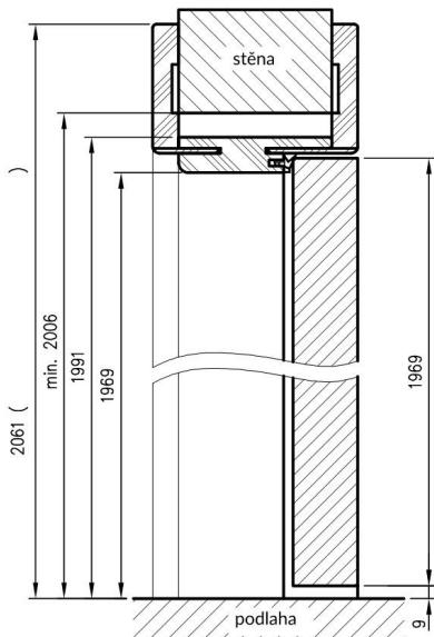
požadovaná výška stavebního otvoru 2006mm
