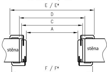
D - Požadovaná šířka stavebního otvoru
