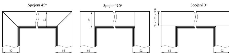
Poznámka: Rám 075-095 má jiný průřez, pro tloušťku stěny 75-89 mm bude nutné zkrátit pero pohyblivého úhlu.
