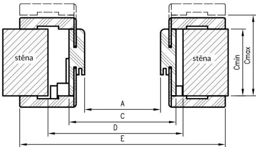
D - požadovaná šířka stavebního otvoru
